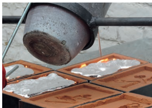
01. Coulée du métal
