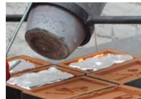
01. Coulée du métal
